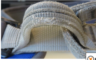
• Point d'encordement usé
